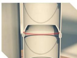
推进器中的o型密封圈（示意）
