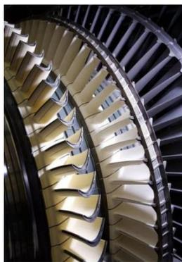
而更多整体铸造叶片的三联叶片，乃至多联叶片技术已被证明均存在不可克服的困难，而被放弃使用。例如前苏联为米格 29 战机研制的 P D-33 发动机采用了三联高压涡轮导向叶片，由于三者互相拉扯，受热应力不均，在使用过程中不断出现多处裂纹，俄罗斯专家已决定今后在设计新发动机时将不再采用三联叶片，而是采用双联叶片。由于单晶叶片在高温下具有极为优异的综合力学性能、组织稳定性和抗氧化腐蚀性能，制造难度也极高，目前只有欧美少数航空企业全面掌握其制备技术，并对我国进行着严密的技术封锁，而双联单晶整体铸造叶片技术难度更高。有资料显示，大尺寸双联单晶导向叶片即使在国外也是属于研制难度较高、合格率较低的一类单晶制品。
