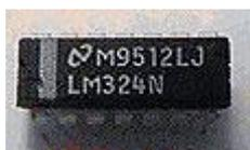
LM324 是四运放集成电路,它采用 14 脚双列直插塑料封装,外形如左图所示。它的内部包含四组形式完全相同的运算放大器,除电源共用外,四组运放相互独立。
